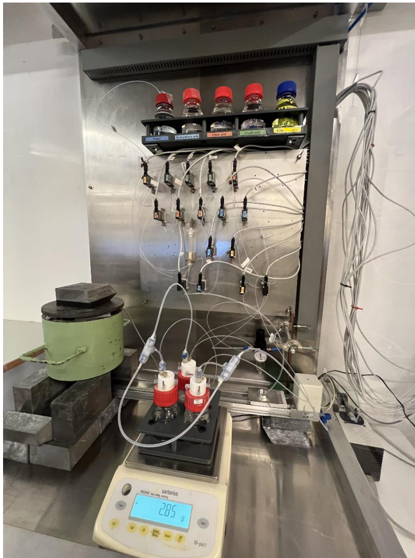
Figur 6-9: Det ferdigstilte oppsettet for generering av ^{234m}\text{Pa} via fjernstyring. Styringssystemet er ikke med i bildet.
