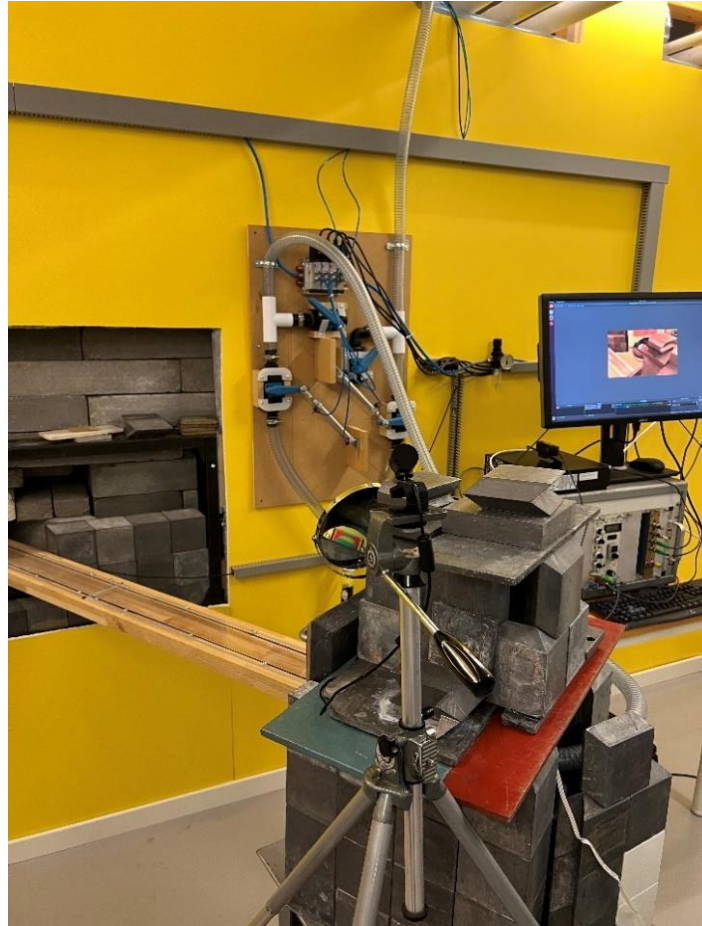
Figur 1-2: Det fysiske oppsettet for NAA-øvelsen. Ventilene som styrer transportskinnen er montert på veggen. Sølvplaten sendes til nøytronaktiveringsposisjon gjennom en passasje i veggen. Brukeren kan se når sølvplaten er tilbake ved detektorposisjon (i blytårnet) ved å blant annet se på refleksjonen i speilet som overvåkningskameraet er rettet mot.
