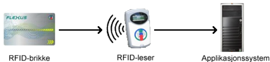
Figur 4.4: Komponenter i et RFID-system
