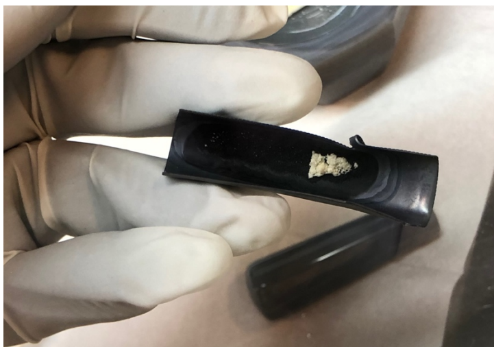
Figur 4.1.3. Ni-digel med sort overflate-lag. Pulveret i digelen er vakuumbehandlet \text{Na}_2\text{O} .
