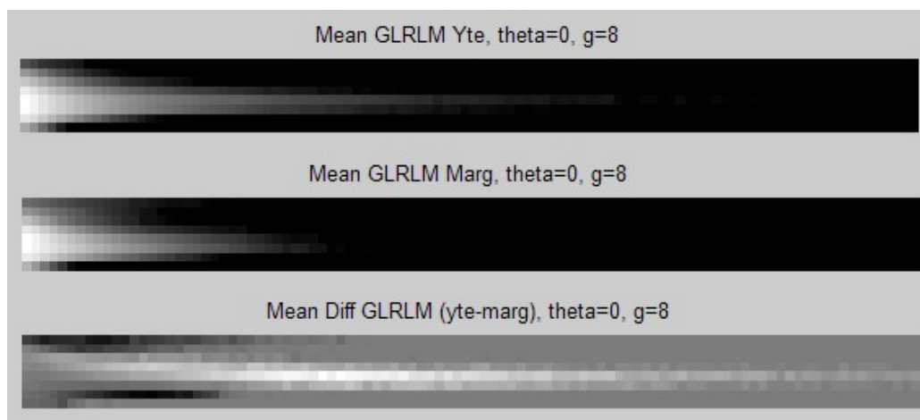
Figur 7.18: Midlere GLRLM for yte på prøve 5-29 (øverst) og tilsvarende for marg(midten). Nederst vises en differansematrix der midlere GLRLM for marg er subtrahert fra midlere GLRLM til yte. Plottene er gjort logaritmiske etter formelen p_{\log}(i, j|\theta) = \log(1 + p(i, j|\theta)) for å lettere oppdage forskjeller i lengre “runs” som er sterkt underrepresentert i antall. En viser her utsnitt av matrisene fram til “runlength” R = 100 .
