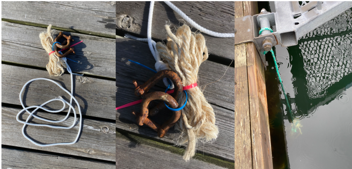
Figur 12: Til venstre og midten: Faunafelle med lodd og tau. Til høyre: Faunafelle som er satt ut i vannet og festet til brygge-elementet.
