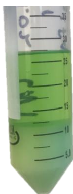
Figur 50: Fotografi av moderlaken og utfelt kalsiumnitrat tetrahydrat etter salpetersyreutlaking.
