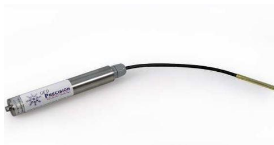
Figur 15. Temperaturlogger som ligner RW1, RW3 og RW4 som dataene er hentet fra. Sylindren inneholder batteri og minne, med ledningen med selve sensoren i enden som plasseres i borehullet.
