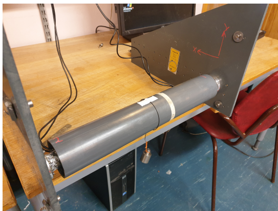
Figur 3.4: Bilde av sylindren på stativet, med lodd som henger på for kalibrering.
