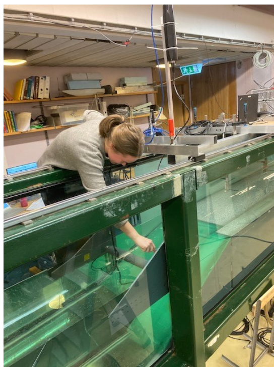
Figur 3.3: Bilde av at sylinderen med stativ skrues fast i skinna i tanken. Grunna og såvidt UL-probene kan sees til høyre i bildet.
