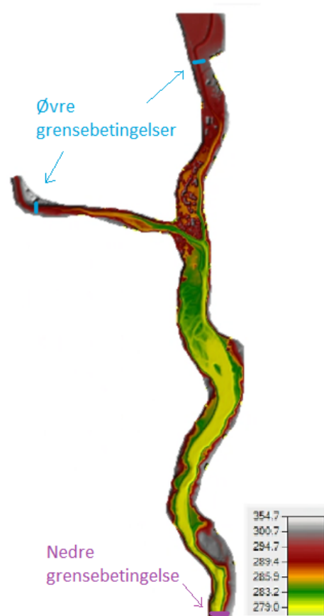
Figur 26: Terrengmodellen for studieområdet i meter over havet. Nedre grensebetingelse er vist med lilla strek og de øvre grensebetingelsene med blå streker.
