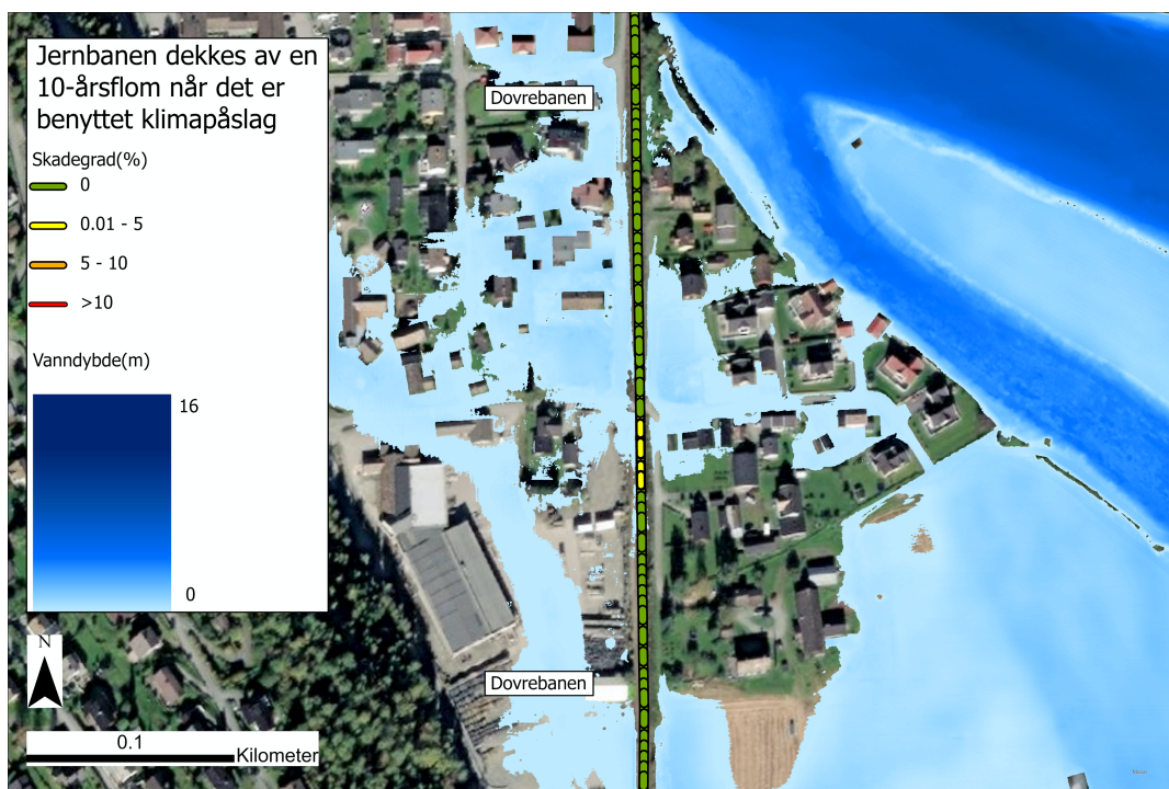
Figur 68: Figuren viser vanndyp og skadegrad ved en 10-årshendelse (med klimapåslag). Illustrert er et svakt punkt på jernbanen som vil føre til at jernbanen stenger ved en 10-årshendelse. Det svake punktet er illustrert med gul fargekode. Lokalisering til figuren er markert som «lokasjon nr.3» i Figur 57.
