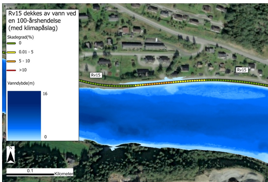
Figur 72: Figuren viser vannndyp og skadegrad ved en 100-årshendelse (med klimapåslag). Illustrert er et svakt punkt på Rv15 som vil føre til at veien stenger ved en 100-årshendelse. Lokalisering til figuren er markert som «lokasjon nr.3» i Figur 57.
