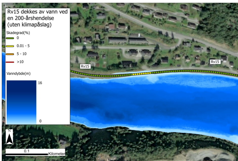
Figur 71: Figuren viser vanddyb og skadegrad ved en 200-årshendelse (uten klimapåslag). Illustrert er et svakt punkt på Rv15 som vil føre til at veien stenger ved en 200-årshendelse. Lokalisering til figuren er markert som «lokasjon nr.3» i Figur 57.
