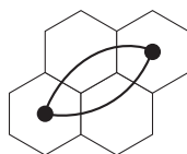
Figur 5.2: Visualisering av en bro der de kurvede linjene representerer en virtuell kobling mellom cellene
