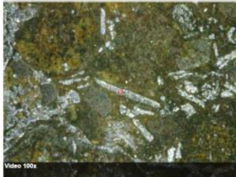
Figur 6: Hammerskæl ses som tynde plader i en masse af korrosionsprodukter,
