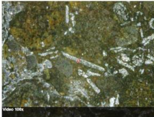
Figur 30: Hammerskæl ses som tynde plader i en masse af korrosionsprodukter,
