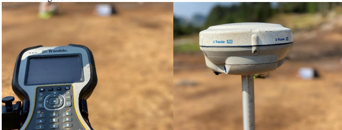
Figur 9 Eksempel på innmålingsutstyr brukt på E39 Kanten-prosjektet. T.v. En TSC3 målebok. T.h. Trimble R6 GPS med CPOS-presisjon. Foto: D. O'Leary/KHM.
