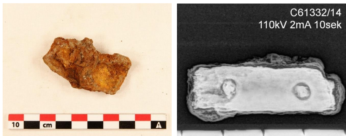
Figur 59 Til venstre C61332/13, rektangulært fragment av jern. Til høyre røntgenbildet av det rektangulære jernfragmentet C61332/14 som viser at under- og oversiden antakelig er klinket sammen med to små nagler, Cf53287_972-3 Røntgen: Birgit Wilster Hansen.
