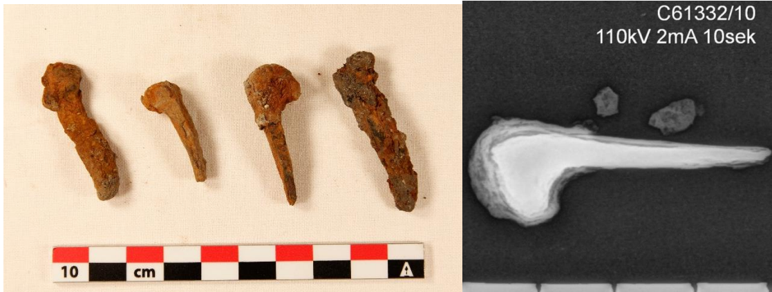
Figur 58 Til venstre hesteskosøm fra tuft 1, C61332/8-11 Cf35273_173, Foto: Lisbeth Skogstrand. Til høyre røntgen av C61332/10, Cf53287_971-9 Røntgen: Birgit Wilster Hansen.
