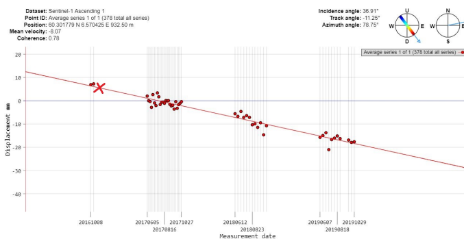
(b) Bevegelse målt med InSAR i ascending bane. Dato for utrasing er markert med et rødt kryss på grafen. Den gjennomsnittlige hastigheten (basert på 378 datapunkt) er 8.07 mm/år. Koherens = 0.78.
