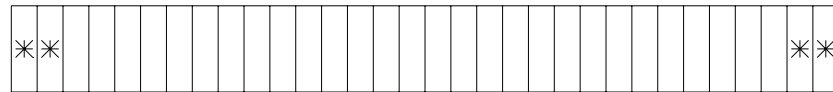
Figur 7.14: Illustrasjon av arrayet benyttet i simuleringene med alle elementene bortsett fra de ytterste parene fjernet. Benyttet til estimering med ESPRIT.
