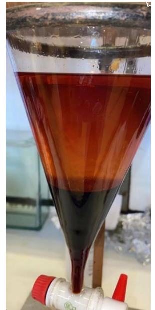
Figur 4.2 Væske-væske ekstraksjon med diklormetan (DCM)
