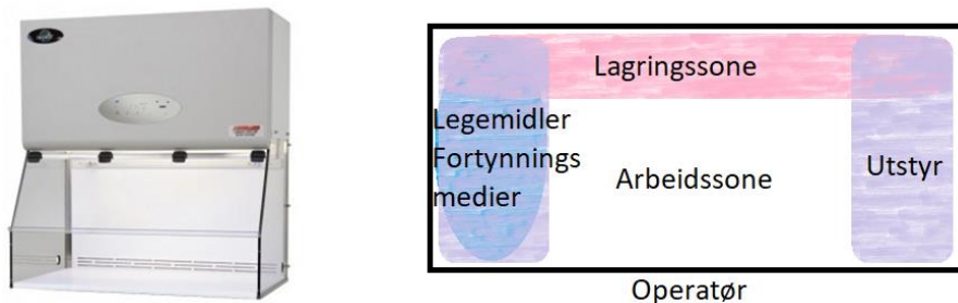
Figur 5.4: Bilde av LAF-benk (venstre) og skjematisk fremstilling organisering av benk og arbeidssone under opparbeidelse av prøver (høyre). LAF-benk fra (Nerliens Meszansky)
