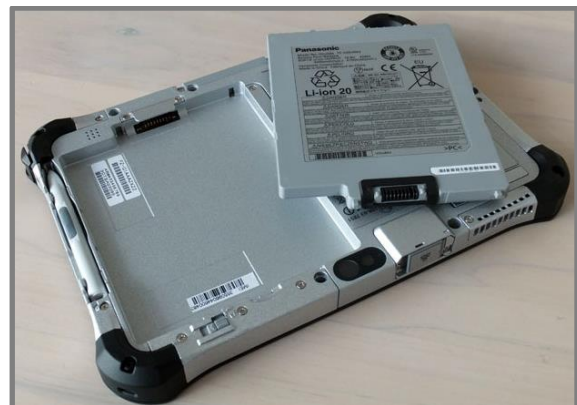
Figur A8e: Muligheten for batteribytte i felt er viktig. Foto: Anders Bryn, 2015.
