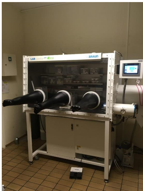
Figur 19 Argonfylt hanskeboks benyttet I dette arbeidet av typen Mbraun Labmaster pro.
