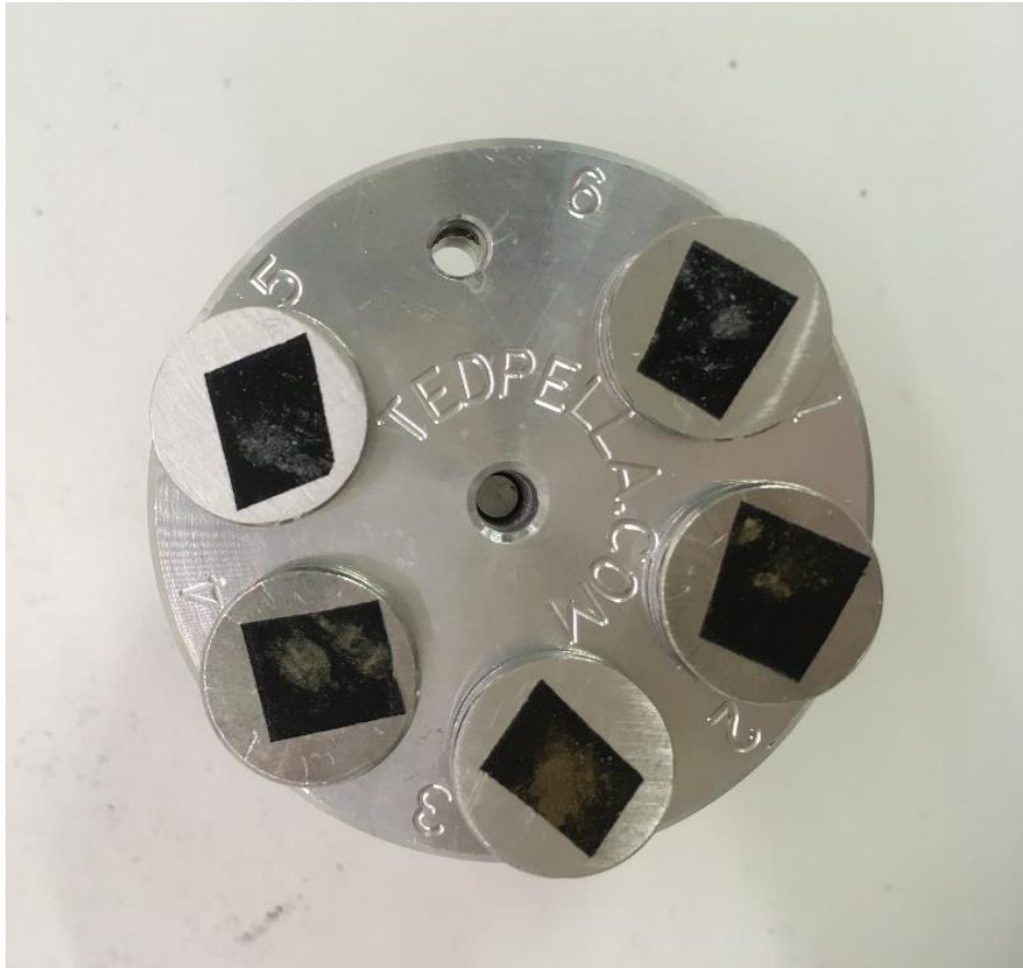
Figur 24 Prøveholder til SEM med karbonteip og prøve.
