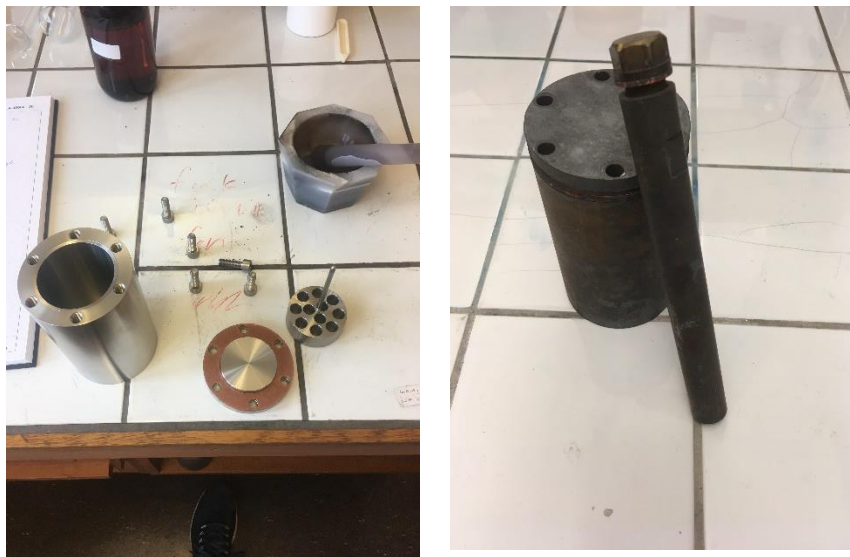
Figur 21 Autoklaver, morter og pistill. Til venstre vises en ubrukt multi-autoklav med prøveholder, skruer og kobberpakning. Til Høyere vises singel og multi-autoklav etter varmebehandling.
