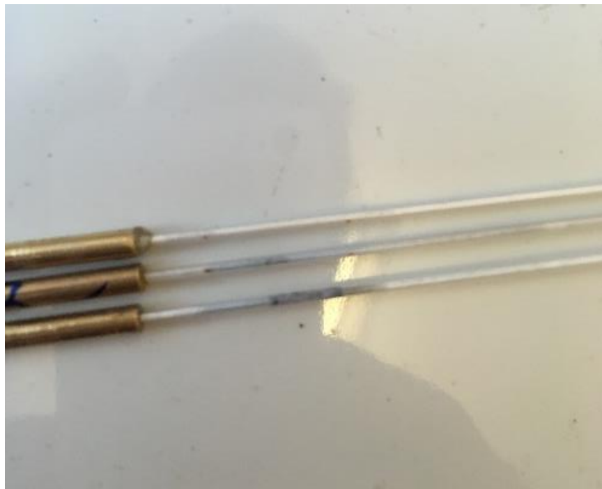
Figur 23 Safirkapillær fylt med sølv (øverst) og reaksjonsblanding (de to nederste). Montert på messingstav som passer i Debye-Scherrer geometri.
