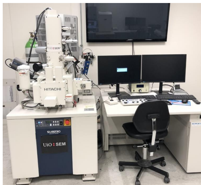
Figur 43: SEM-instrumentet som ble brukt i arbeidet, en Hitachi SU8230 Ultra High Resolution Cold FE-SEM.
