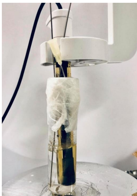
Figur 48: Oppsett for inerte elektrodemålinger. Toppen av sylinderglasset er dekket med parafilm, med en lang sprøytespiss som bobler Ar-gass ned i nanopartikkelsuspensjonen.
