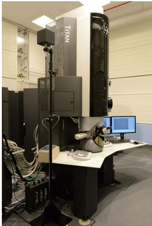
Figur 44: TEM-instrumentet som ble benyttet i dette arbeidet, en FEI Titan G2 60-300 kV. Bildet er hentet fra [127].
