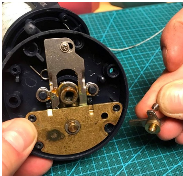
Figur 30: Metalltapp som ble fjernet fra innsiden av fiskesnellen, slik at den kan rotere begge veier uhindret
