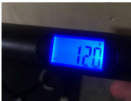
Figur 40: Drakraft målt ved hjelp av bagasjevekt
