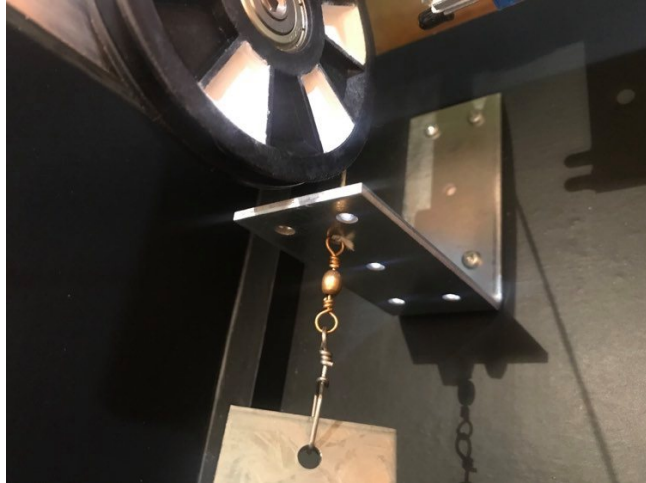
Figur 33: Fysisk blokk som sørger for at kranen heies opp til samme punkt hver gang
