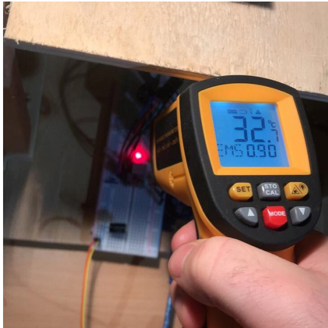
Figur 38: Infrarødt termometer brukt til å måle temperaturen på motorkontrolleren
