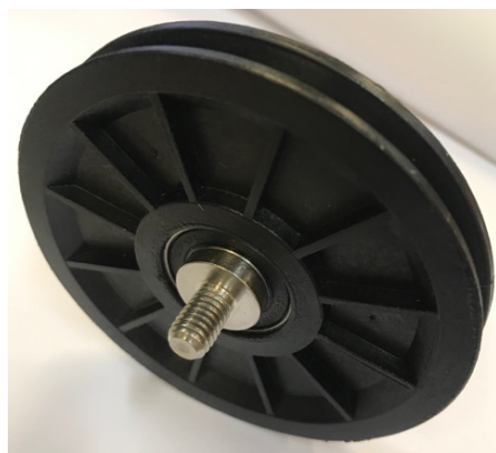
Figur 21: Trinsen som blir brukt i prosjektet
