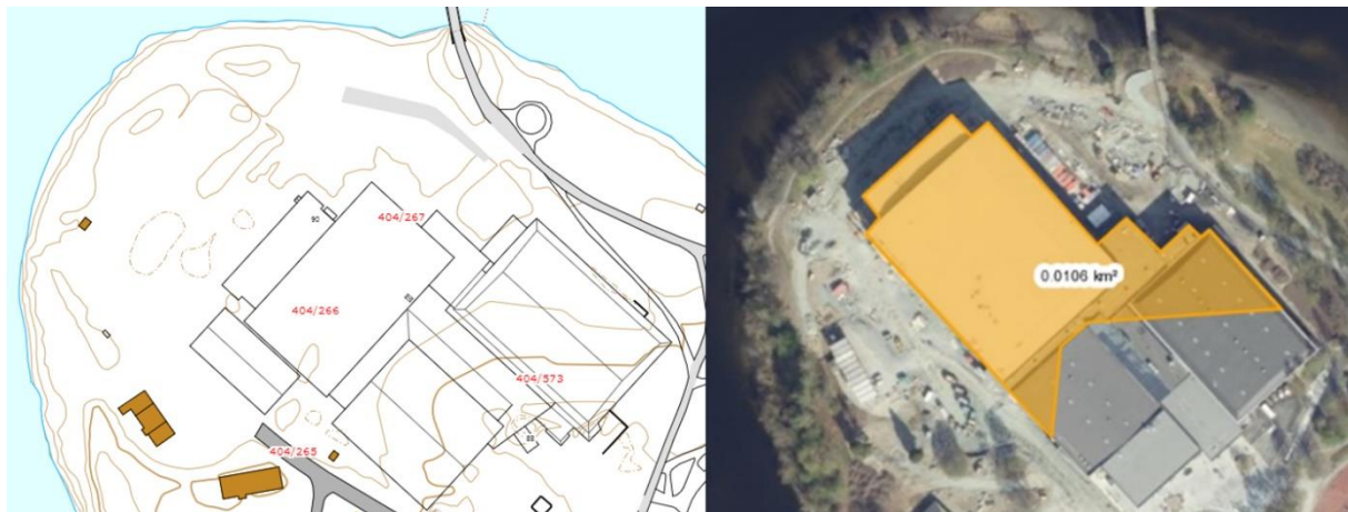
Figur 3 Trondheim kommunes aktsomhetskart (venstre) med høydekoter og 1 meter ekvidistanse viser gamle Nidarøhallen. Kartverkets norgeskart.no (høyre) med arealmål etter 4 meters koten viser nye Trondheim Spektrum
