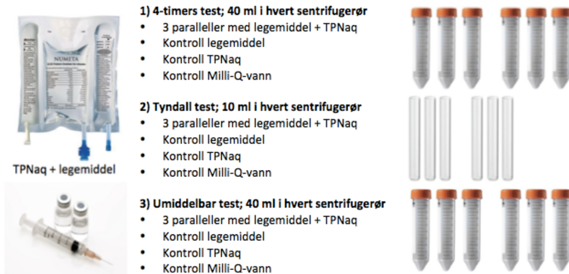
Figur 3.3 Oversikt over prøveopparbeidelse i kronologisk rekkefølge (1-3) for test av utfelling med legemiddel + TPNaq
