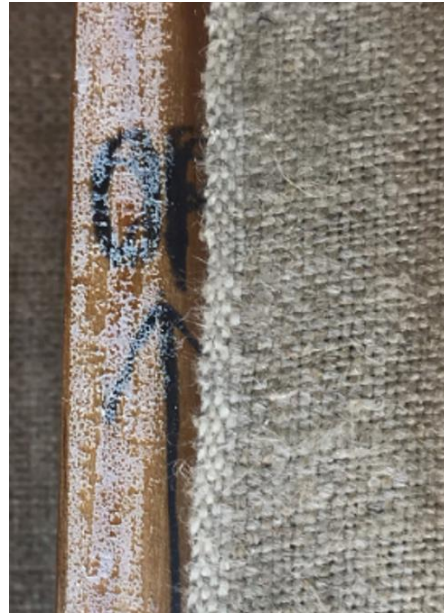
Fig 70) Fjerning av sekundær rammemakertape på baksiden av blindrammen som ble fuktet med vann og fjernet med skalpell. Limrester satt fast i treverket og kunne fjernes ved hjelp av bomullspinne fuktet med etanol (og kun skalpell oppå vannsensitiv blyantinskripsjon).
