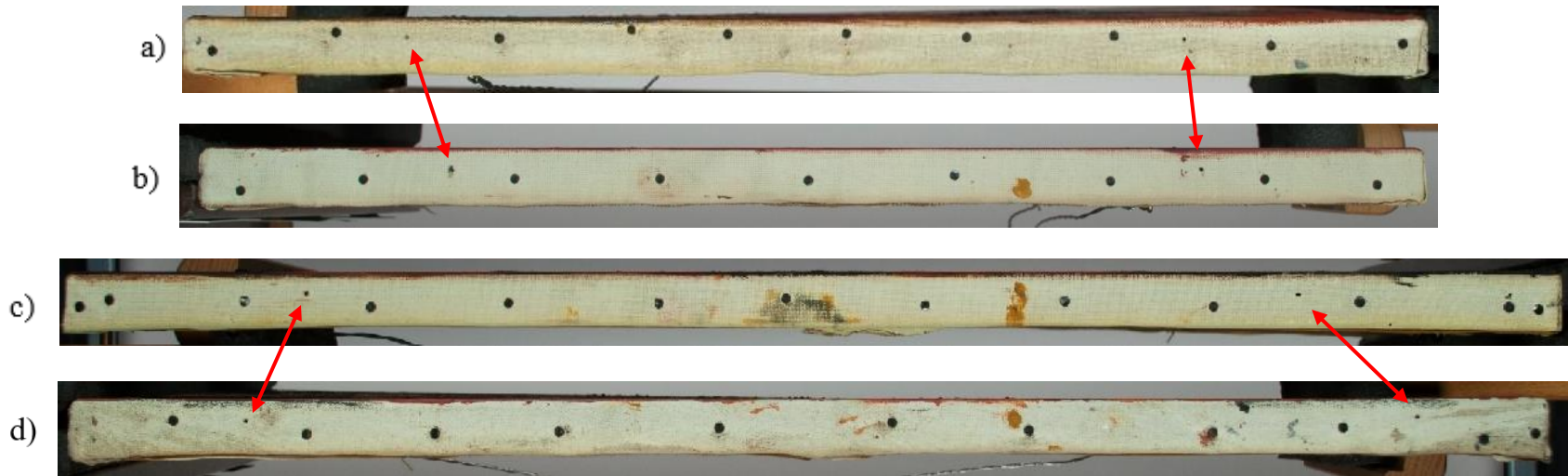
Fig 28) Oppspenningskantene. a) venstre oppspenningskant, b) høyre oppspenningskant, c) Øverste oppspenningskant, d) nederste oppspenningskant. Rød pil viser hull som sannsynligvis er fra den tidligere monteringen av den originale pynterammen.
