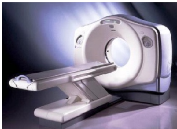
Figur 2.2: CT maskinen med røntgenrør og detektor. Rotasjonen rundt pasienten gir mulighet for elektriske impulser konvertert til digital informasjon for 3D avbildning av anatomi (11).
