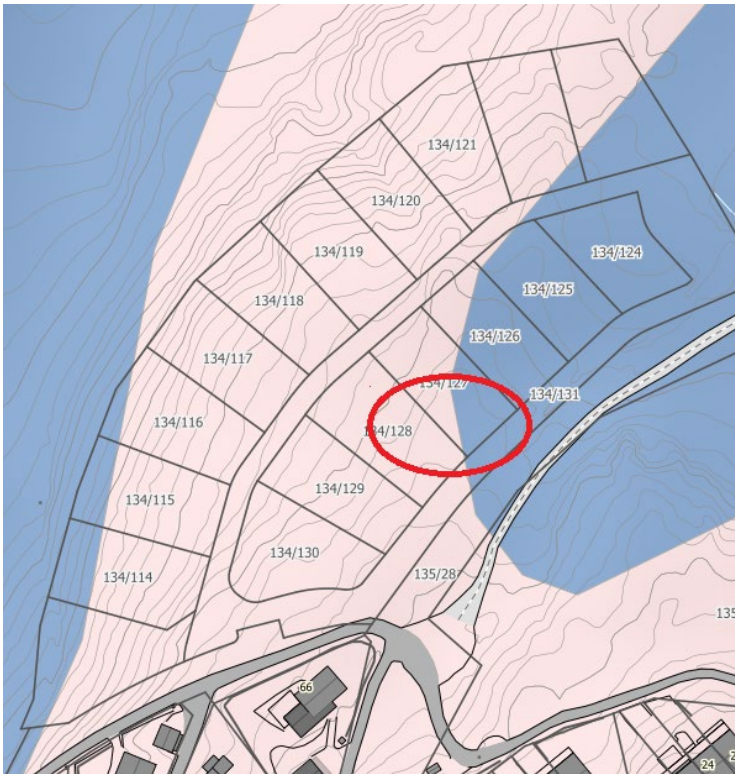
Figur 2: Utdrag av løsmassekart fra NGU med utgravningsområdet markert med rødt. Rosa farge indikerer bart fjell, dvs. at mer enn 50 % av arealet er fjell i dagen. Blå farge indikerer marine strandavsetninger. Hentet fra http://geo.ngu.no/kart/losmasse_mobil/ . Kart bearbeidet av Solveig Lyby, KHM.
