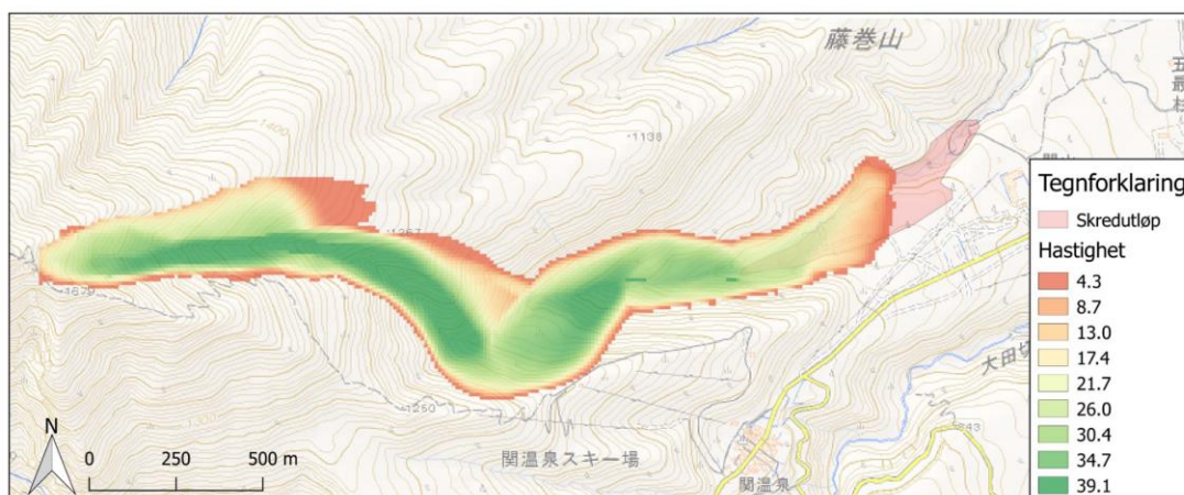
Figur 54: Simuleringsresultatet fra MoT-Voellmy, med modellerte hastigheter (m/s) fra tilbakeberegning av skredhendelsen i Makunosawa, Japan 2008. Rosa område viser observert skredutløp. MoT-Voellmy klarte ikke å simulere skredet inn i sederskogen.
