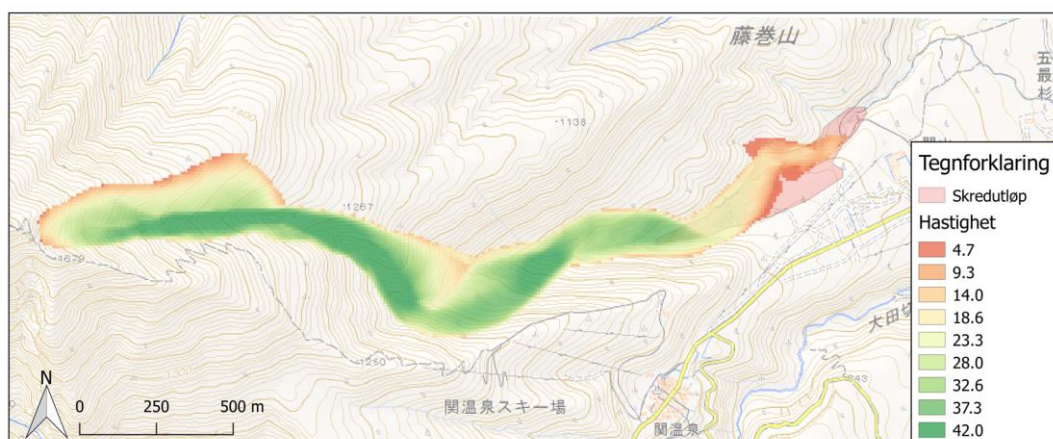
Figur 53: Simuleringsresultatet fra RAMMS, med modellerte hastigheter (m/s) fra tilbakeberegning av skredhendelsen i Makunosawa, Japan 2008. Rosa område viser observert skredutløp. RAMMS klarte ikke å simulere skredet inn i sederskogen.
