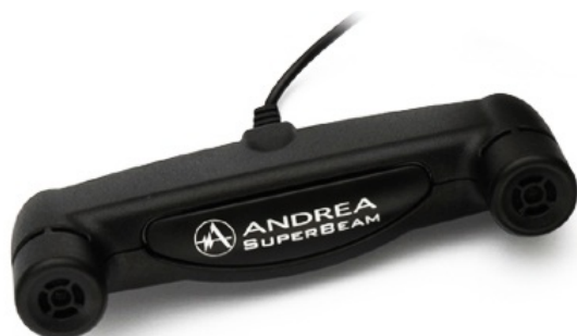
Figur 8: Simpleste formen av en mikrofonmatrise med en mikrofon plassert på venstre siden og en på høyre siden
