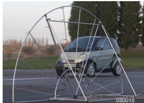
(b) Halv-formet sammenleggbar mikrofonmatrise brukt på bil
