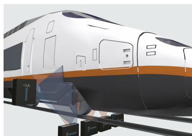
(a) Inspeksjon gjort med Chromasens skanner fra kanter
