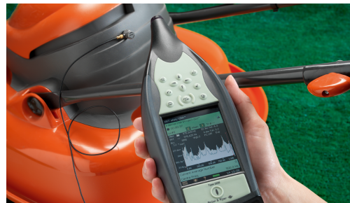
(b) Håndholdt mikrofonmatrise brukt på en gressklipper
