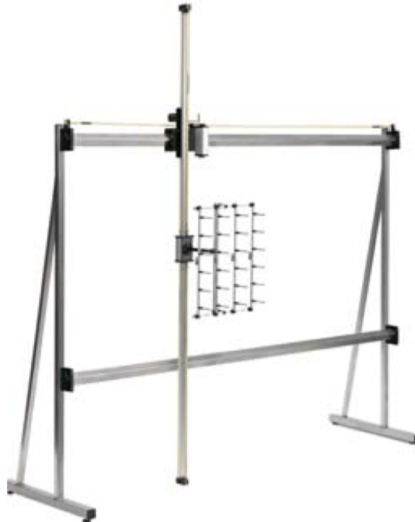
(b) Grid mikrofonmatrise med 2D-robot
