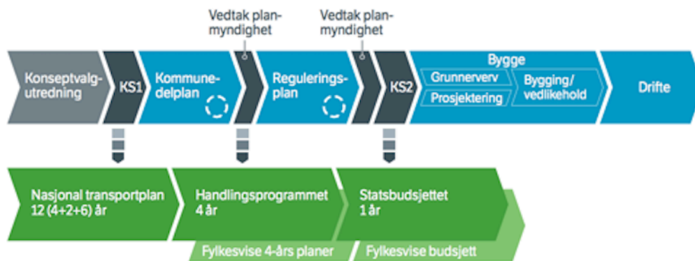
Figur 4: Sammenhengen mellom styringsdokumentene og de ulike fasene i et veiprojekt. Hentet fra Vegdirektoratet (2018b).
