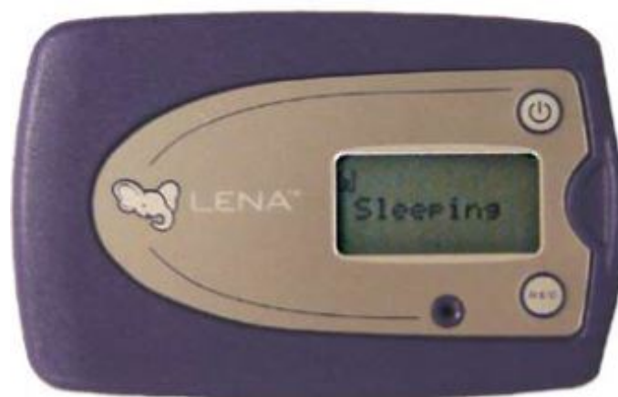
Figur 1: Digital Language Processor (DLP) vist i naturlig størrelse. Fra "The LENA language environment analysis system: Audio specifications of the DLP-0121" av Ford et al., 2008. Copyright 2008 LENA Foundation. Gjengitt med tillatelse.
