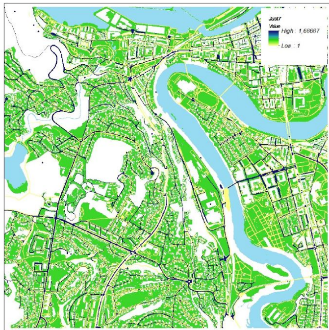
Figur 2.1: Malmin et al. (2016) sin versjon av et kostnadsraster. Høyere verdier tilsvarer mer motstand. Hvite verdier er barrierer.
