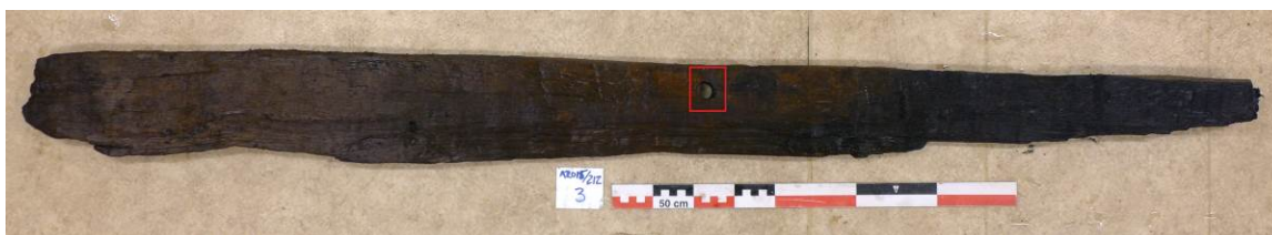
Figur 20: Eikeplank C60182/15. Gjennomhulling med bor markert med rød boks (Cf34954_029_C60182_15.jpg). Målestokk er 50 cm. Foto: Vegard Vike, KHM, UiO.
