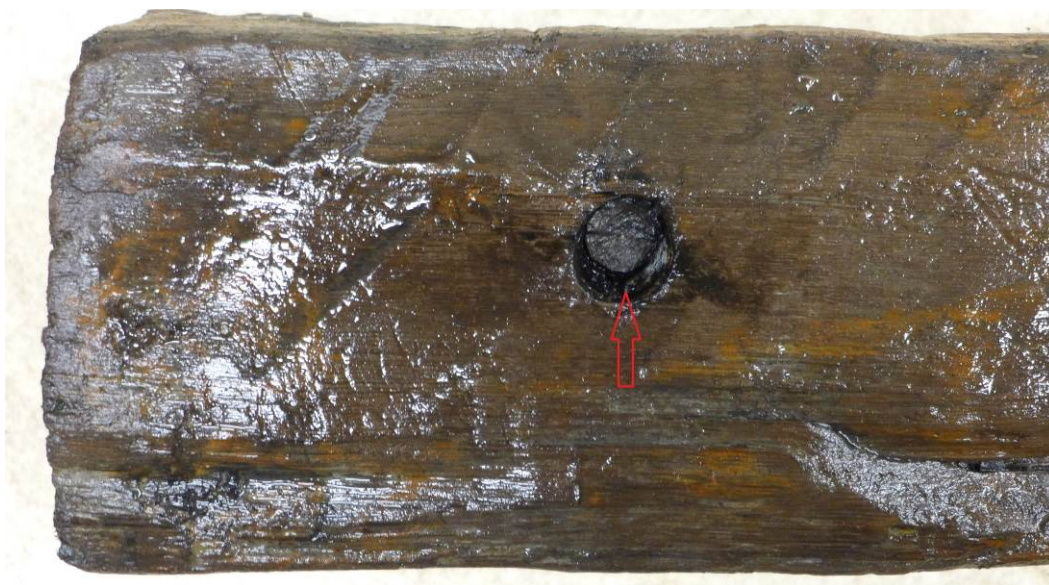
Figur 23: Detaljfoto av eikeplank (C60182/17) med del av treplugg i gjennomhulling (Cf34954_034_C60182_17.jpg). Foto: Vegard Vike, KHM, UiO.
