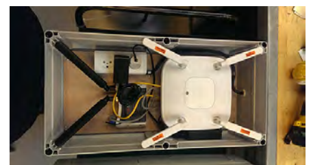
Figur 2. Boksen opsat i lysmasterne med access-punkt, krypteringsboks og 4G high-speed WiFi-modem.
