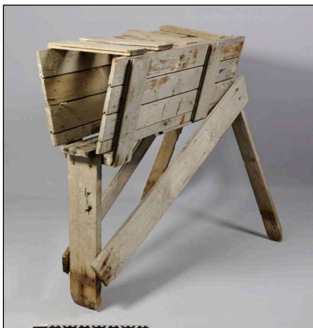
Figur 9: Selvskudd for isbjørn fra Kapp Linné. Laget av bestyrer Tvedt ved Isfjord Radio ca. 1953/54. I denne modellen ville åte ligget i den ene åpningen, festet til avtrekkeren på et gevær, som var installert til den andre enden av kassen. Foto: Svalbard Museum.
