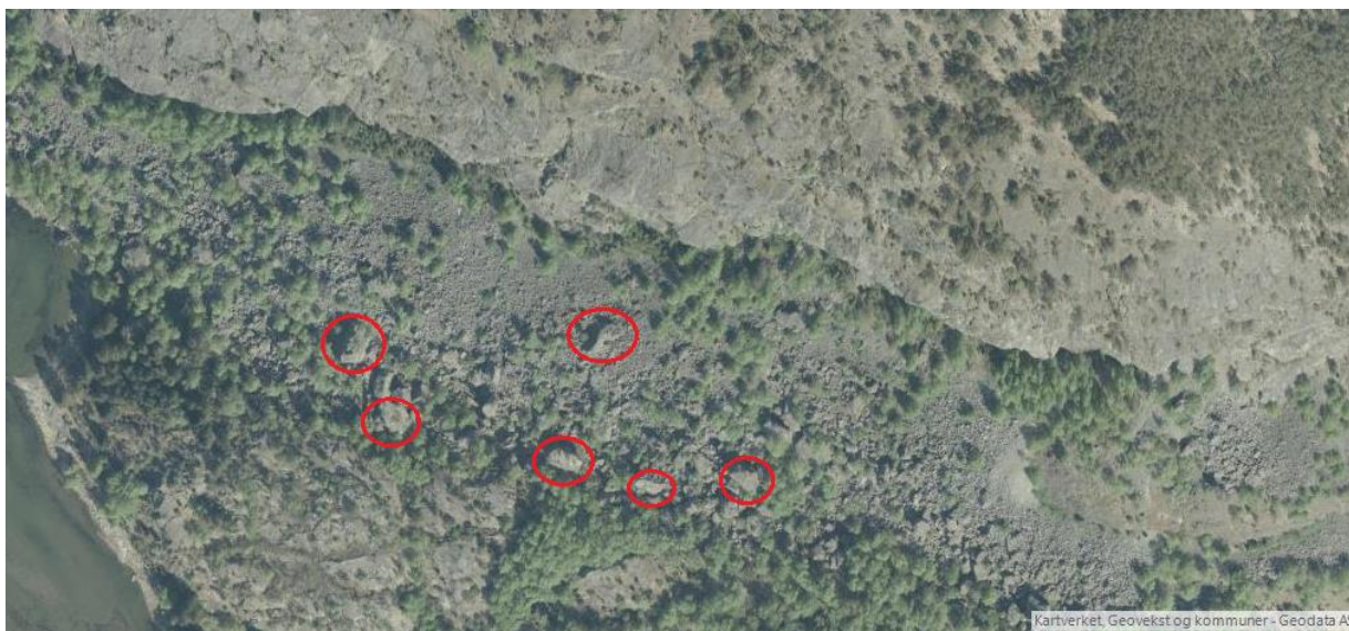
Figur 79: Flyfoto over ura ved Lærdal Vest. Røde ringe markerer blokker med diametere på over 10 meter.
