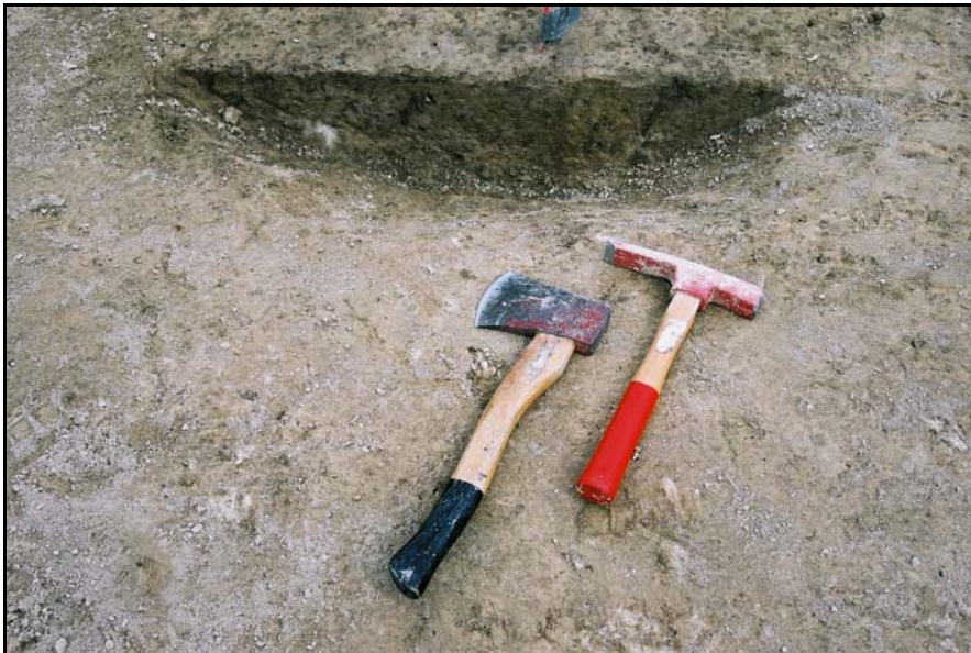
Bilde 3 De mest effektive graveredskapene i leirundergrunnen viste seg å være øks og hakke.
