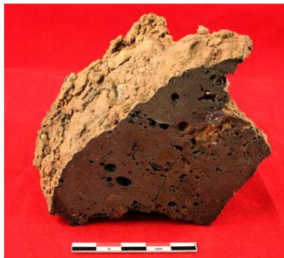
Figur 3. Slaggen C57539/18 i delat tvärsnitt. Till vänster den svängda kant som slaggen stelnat mot. I snitt framträder slaggens homogena sammansättning.
