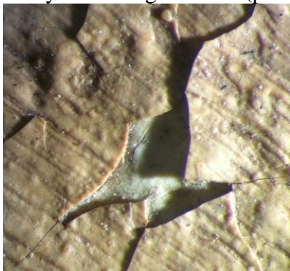
Fig. 46: Fargetap og oppskalling av fargelag. Arbeidsmikroskop (40x).
