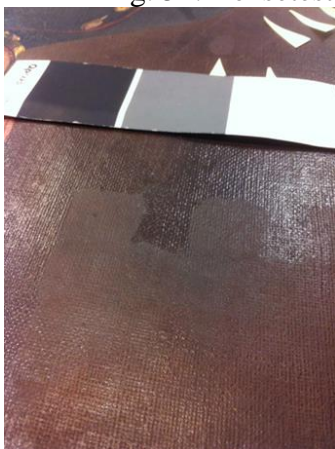
Fig. 56: Rensing med gel ble utført i ruter på ca. 2 x 2 cm.
