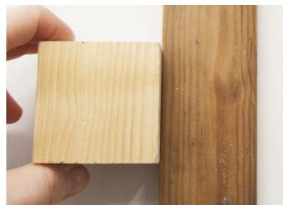
III. 13 Treverket på innsiden blindrammen sammenlignet med en bit furu.
