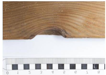
III. 19 "B-2299" er skrevet til venstre på øverste rammelist av blindrammen. Illustrasjonen viser også spor etter strekmott og et annet verktøy som er bukt til å sette tre prikker i hvert hjørne av blindrammen.
