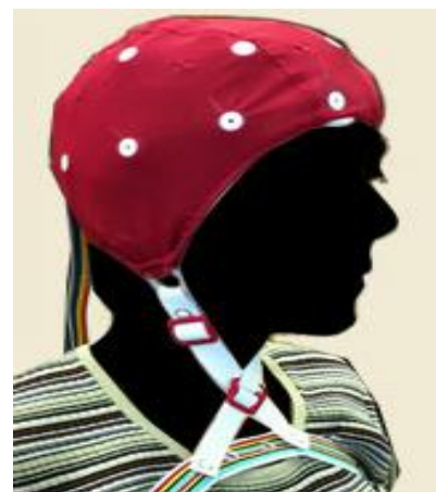
Figur 9. Elektrode hette med 19 kanaler som brukes under trening med QEEG neurofeedback, hentet fra (medicine.mcgill.ca).
