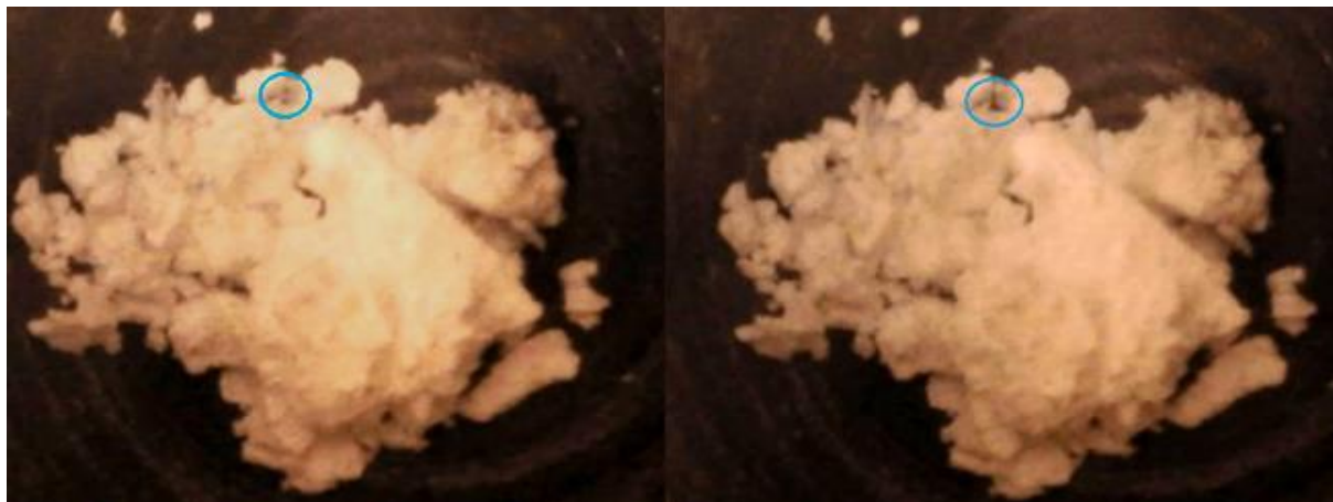
Figur 27: Dokumentering av første synlige endring av melamincyanurat under oppvarming, markert med blå sirkel. Bildet til venstre er tatt 30 sekunder før bildet til høyre, og temperaturen er 170 °C. Dimensjonene i bildet er tilnærmet 1,0 x 0,7 cm 2 .
