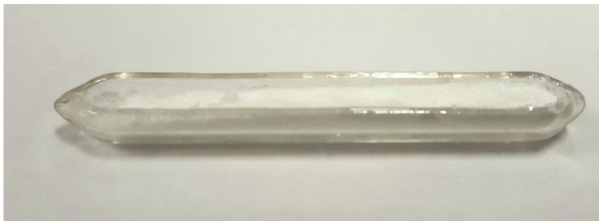
Figur 21: Åpen forløperbåt fylt med melamin. Denne typen båt ble benyttet for alle avsetninger hvor melamin eller cyanursyre inngikk. Dimensjonene til forløperbåten er \sim 7 \times 1 \text{ cm}^2 .
