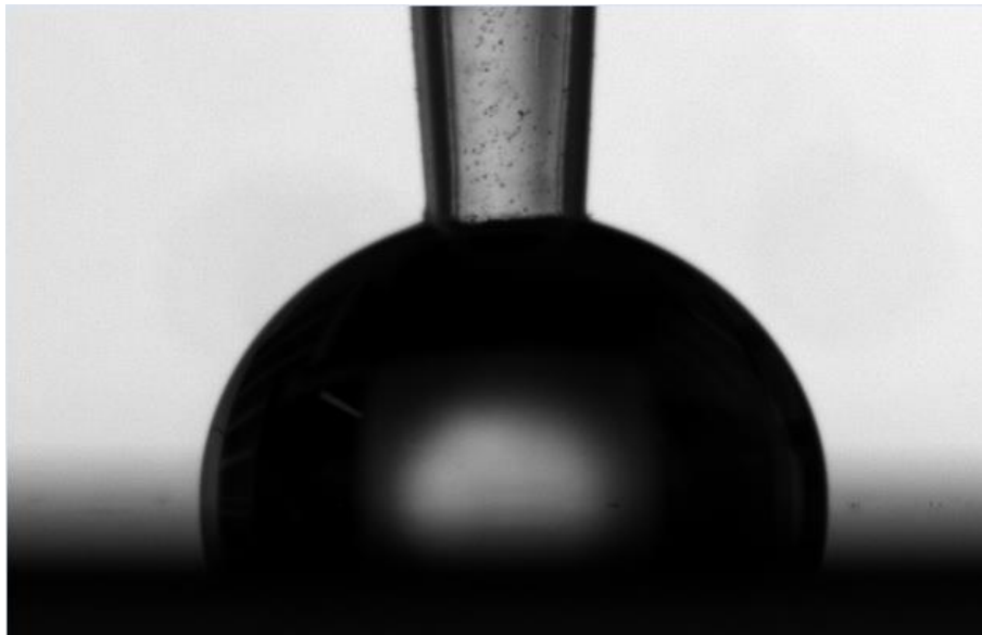
Figur 37: Målinger gjort med goniometri for å undersøke kontaktvinkler. Figuren viser vanddråpe på en film av DEZ/CA avsatt ved 380 °C.
