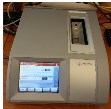
Figur 2.10 Prinsippet for et polarimeter (t.v.) (Pedersen-Bjergaard et al. 2004), og et polarimeter ved FI (t.h.).
