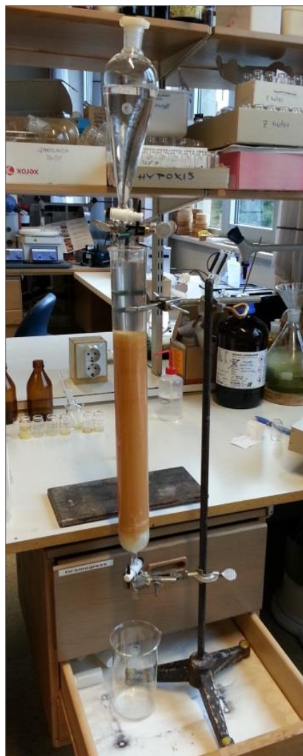
Figur 2.4: Sephadex™ LH-20 kolonne ved FI.
