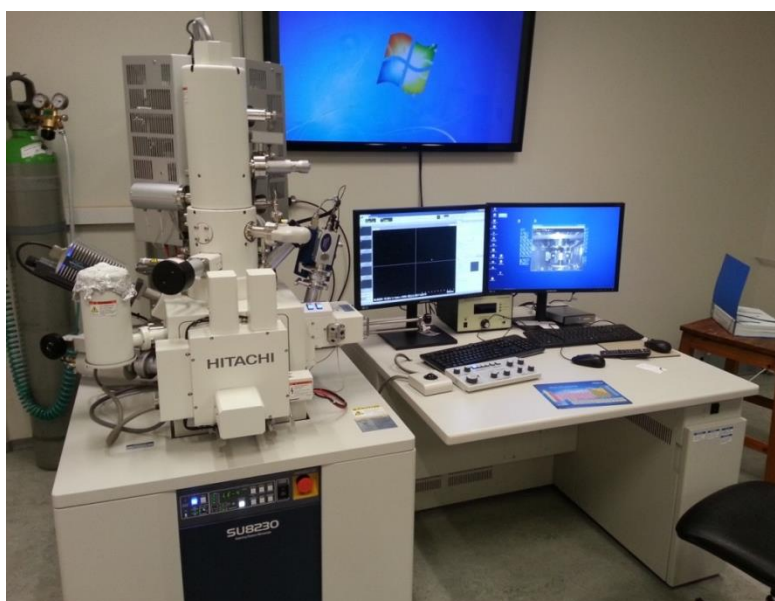
Figur 17: Hitachi SU8230 Sveipeelektronmikroskop brukt til karakterisering av topografien til overflater i denne oppgaven.
