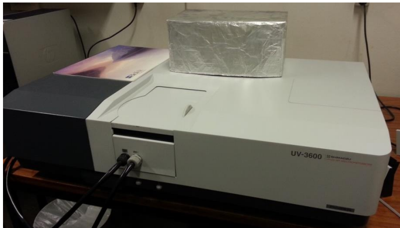
Figur 18: Shimadzu UV-3600 UV-VIS-NIR Spektrometer brukt til å måle transmittans i denne oppgaven.
