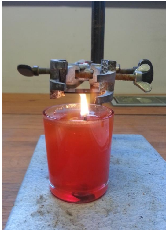
Figur 26: Påføring av karbontemplat på en glassplate ved bruk av stearinlys.
