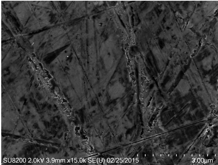
Figur 51: SEM bilde av en silisiumskive strukturert med sandpapir med ruhet P# 2400 og P# 4000 for å oppnå en ruhet i mikrometerskala.
