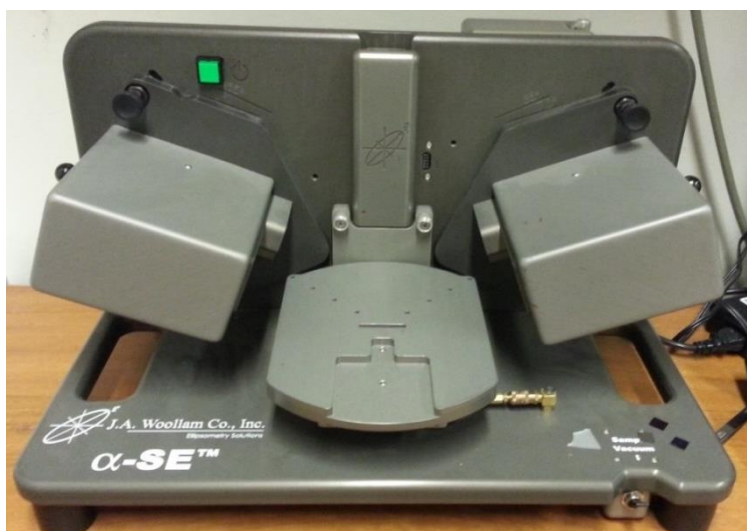
Figur 16: \alpha -SE fra J.A. Woollam Co., Inc. Brukt til måling av filmtykkelse på \text{SiO}_2 og \text{TiO}_2 .
