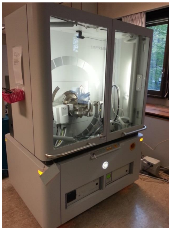
Figur 19: PANalytical Empyrean instrument brukt til lavinnfallsvinkelrøntgendiffraksjon på tynne filmer.
