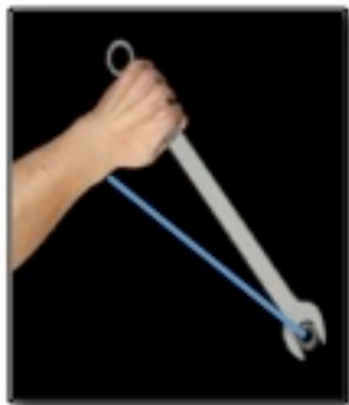
Figur 3: Den vinkelrette avstanden fra dreiepunktet og ut til armen
