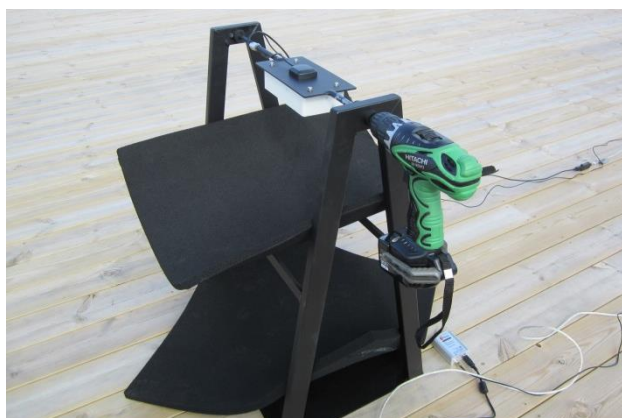
Figur 27 Rigg benyttet under forsøkene. De svarte kvadratene er matter for å forhindre refleksjoner.
