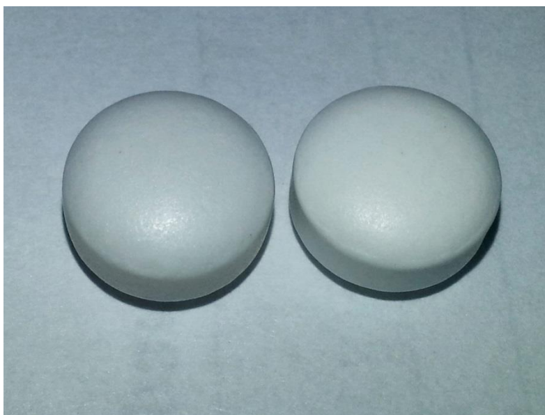
Figur 32 Visuell kontroll av Orfiril Retard 300 mg etter oppbevaring i endoser. Tabletten til høyre er 0-prøve fra original emballasje og tabletten til venstre er prøve fra endose etter 3 måneders oppbevaring i klimaskap 25 °C, 60 % RH
