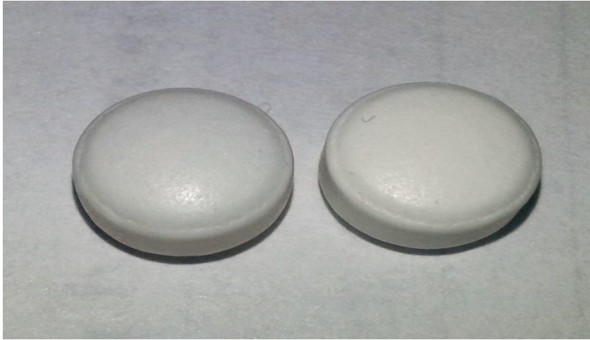
Figur 30 Visuell kontroll av fargeendring hos Orfiril 150 mg enterotablett. Tabletten til høyre er 0-prøve fra original emballasje og tabletten til venstre er prøve fra endose oppbevart i klimaskap i 3 måneder ved (25 °C, 60 % RH)
