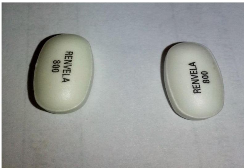
Figur 29 Visuell kontroll av Renvela etter oppbevaring i endoser. Tabletten til høyre er 0-prøve fra original emballasje og tabletten til venstre er prøve fra endoser etter 3 måneders oppbevaring i klimaskap (25 °C, 60 % RH)
