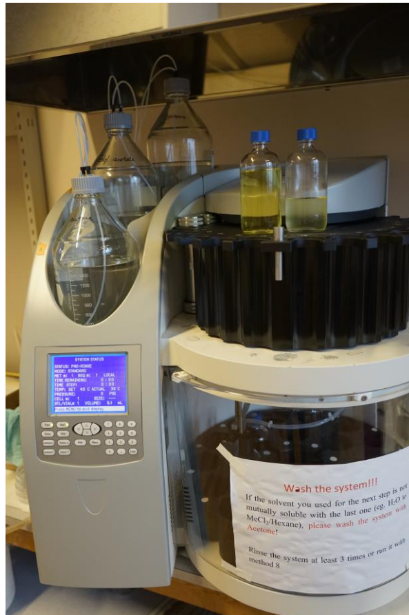
Figur 4-2. Bilde av ASE- maskinen, med to flasker med ekstrakt fra to runder på samme celle. Runde 1 har mørkere eluat enn runde 2.
