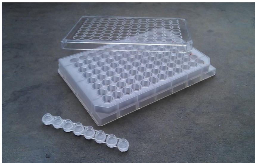
Figur 9: Utstyr til PALME. Foran: Hjemmelaget «akseptorplate». Bak: Donorplate og topplokk.
