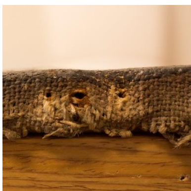
Figur 29: Detalj av oppspenningskanten, hvor rustne spikre har ført til oksideringsskader i det omliggende lerretet.
