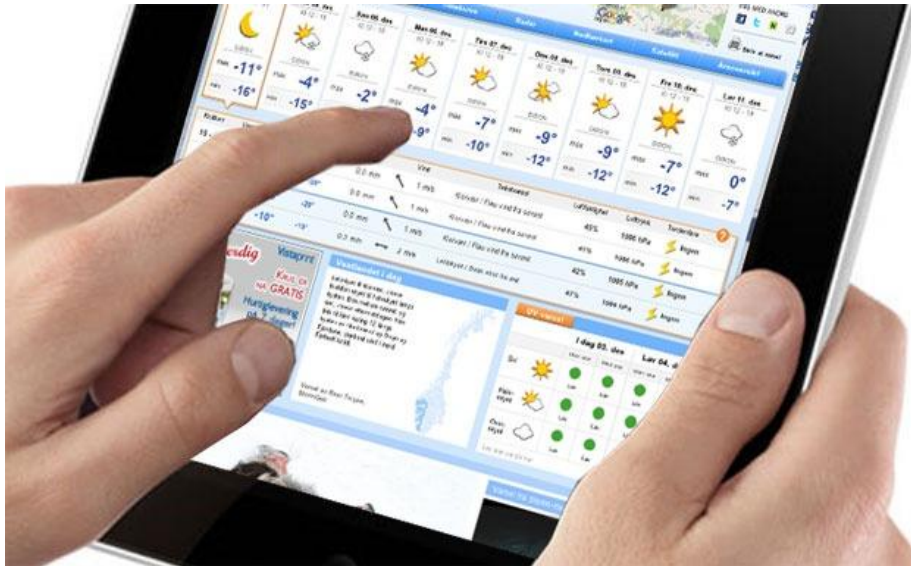
Figur 3. Bilde av en iPad med berøringsskjerm [9]. I iPader benyttes ITO som TCO-materiale. Bruk av TCO-materialer i mobiler og nettbrett er svært vanlig.
