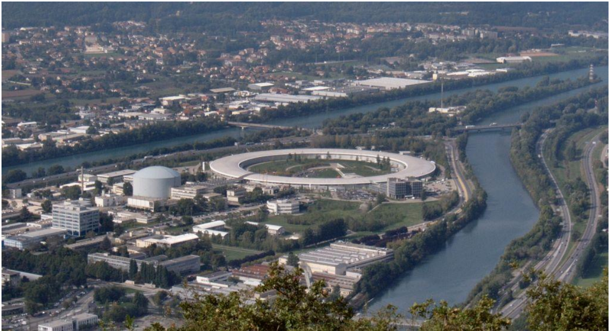
Figur 27. Bilde av ESRF, Grenoble, Frankrike. ESRF er en felles Europeisk fasilitet for synkrotronstråling for 18 europeiske land, Sør-Afrika og Israel. Selve synkrotronringen er 844 meter og elektronstrålen operer med en energi på 6GeV. Bildet er hentet fra [93].
