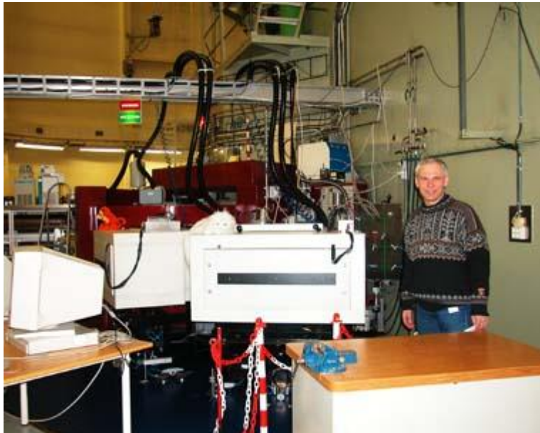
Figur 29. Bilde av PUS-detektoren som benyttes til pulverdiffraksjon. Denne består av to posisjonsensitive ^3\text{He} -detektorer med innsamlingsområde for data på 2\theta - vinkler mellom 10\text{-}130^\circ [95].
